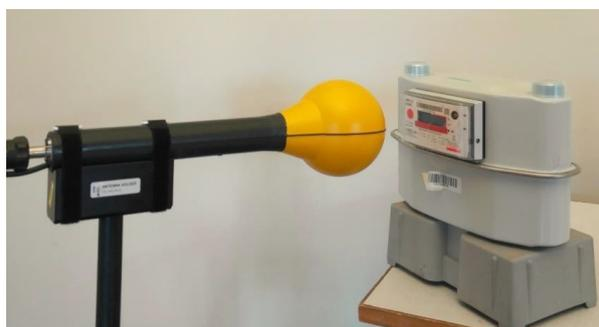
Figure 3 : photo de la mesure devant le compteur gaz
